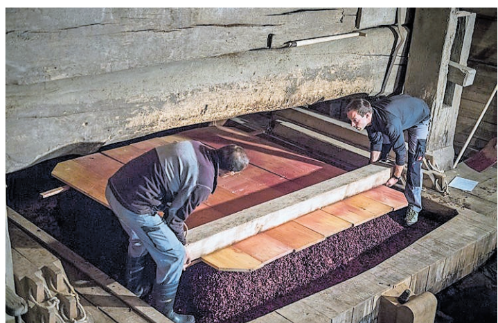
Der Maischekuchen wird mit Brettern und Balken abgedeckt, Önologin Ines Rebentrost dreht die Spindel – und bald sprudelt der kostbare Saft aus der Presse.
