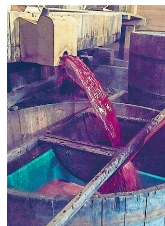
Der Maischekuchen wird mit Brettern und Balken abgedeckt, Önologin Ines Rebentrost dreht die Spindel – und bald sprudelt der kostbare Saft aus der Presse.
