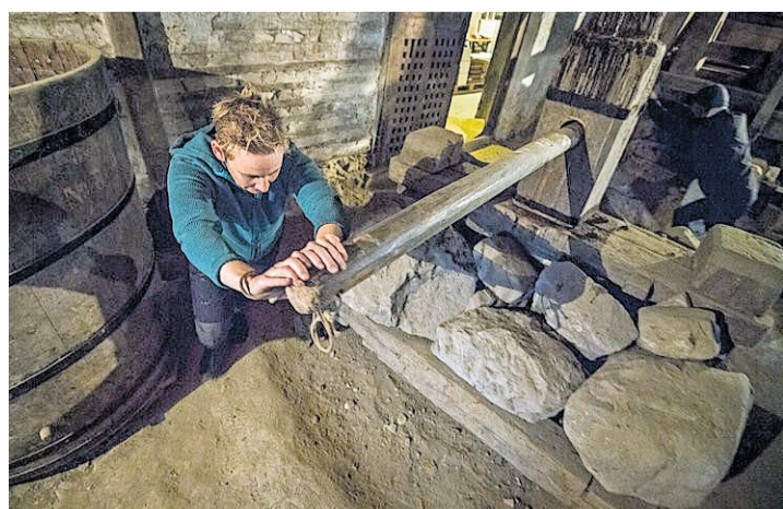
Der Maischekuchen wird mit Brettern und Balken abgedeckt, Önologin Ines Rebentrost dreht die Spindel – und bald sprudelt der kostbare Saft aus der Presse.
